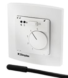
Elektronischer Bodentemperaturregler mit Bodentemperaturfühler (NTC-Normfühler, 4 m Leitungslänge, Fühlerelement Ø 7 x 28 mm) für Fussboden-Temperiersysteme
