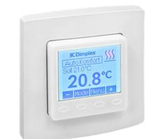
Elektronischer, universal einsetzbarer Raum- oder Bodentemperaturregler (2-Punkt) in Unterputzausführung für Elektro- oder Warmwasserheizsysteme (stromlos geschlossene Stellantriebe) mit digitaler Wochenuhr zur Programmierung von individuellen Komfort- und Absenkezeiten. Bedienung über vier kapazitive Tasten unter dem hinterleuchteten Display. Softwareseitige Umschaltmöglichkeit zur Verwendung als Bodentemperaturregler oder als Raumtemperaturregler mit Bodentemperaturbegrenzer.
